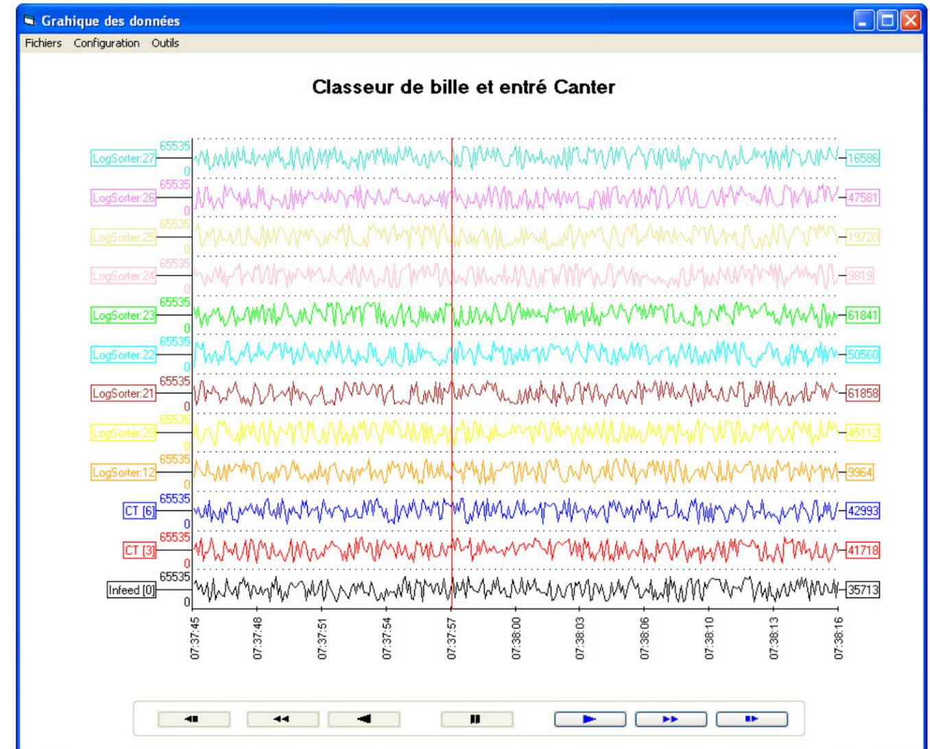
**Le diagnostic d'usine recueille l'information de vos Automates Programmables et les sauvegarde sur base de données pour analyse et génération de graphique permettant d'identifier les blocages et les pertes de temps.**
